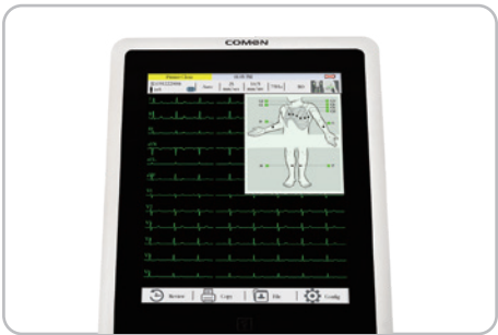
Увеличение карты состояния отведений, показывающей, хорошо ли подключены отведения ЭКГ.
